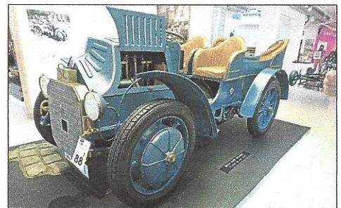
Pionierleistung: Dieser Lohner Porsche Mixte aus dem 19. Jahrhundert hatte bereits einen richtungsweisenden Radnabenantrieb.
