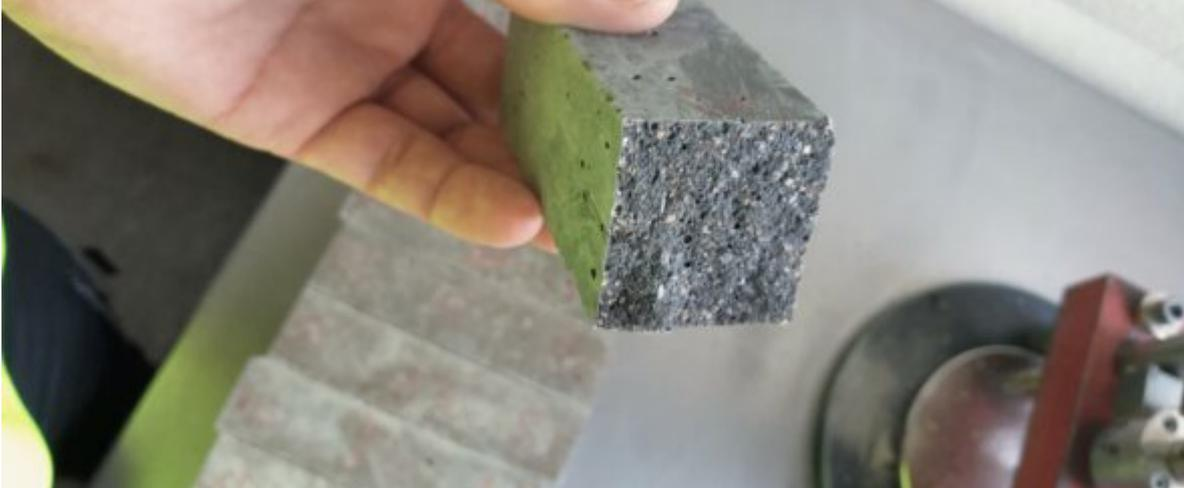
Normenprüfung der Biegezug- und Druckfestigkeiten.
